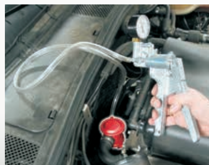
Un outillage simple suffit à contrôler facilement les composants pneumatiques.
