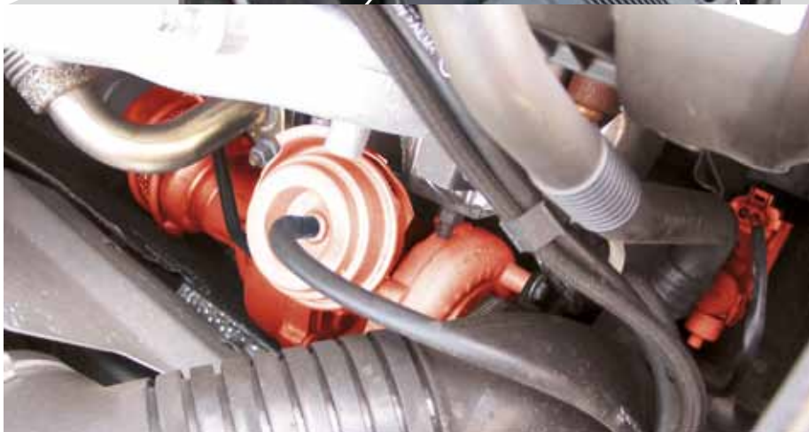
Convertorul electropneumatic de presiune (EPW) și turbina VTG (evidențiat cu roșu) la Audi A4 TDI
