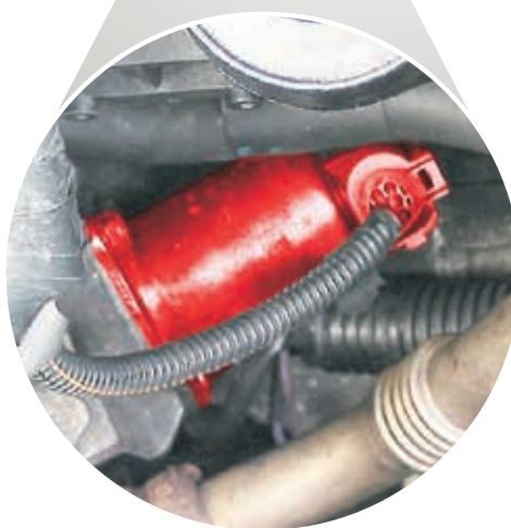
Supapa EGR de la Renault Master JD1M (evidențiată)
