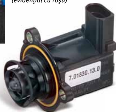
Supapa de descărcare la VW EOS TFSI (evidențiat cu roșu)
