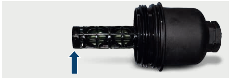
Abb. 2: Bruchstelle am Kunststoffrohr, der Verschluss für das Drainageventil fehlt
