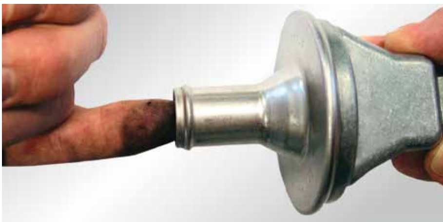
Eenvoudige controle van de terugslagklep
