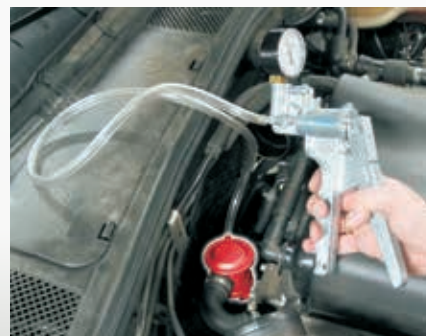
I componenti pneumatici possono essere controllati facilmente con attrezzi semplici.
