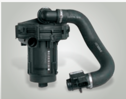
L'insufflazione dell'aria secondaria avviene tramite una pompa aria secondaria che gira a regime elevato.
