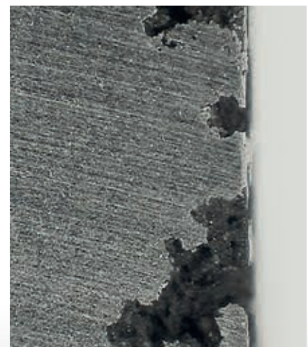
Abb. 2: Querschnitt der Zylinderlaufbuchse
