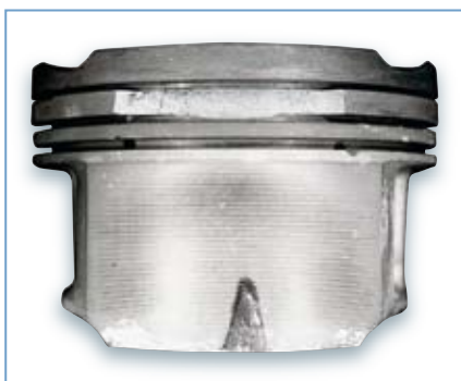
Abb. 1 Ringstegbruch zwischen erstem und zweitem Verdichtungsring
