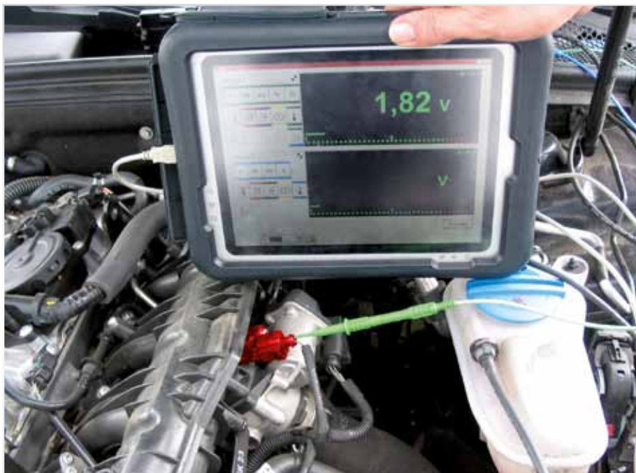
Măsurarea tensiunii inițiale la senzorul de presiune al conductei de admisie (evidențiat) la Audi A4 TFSI
