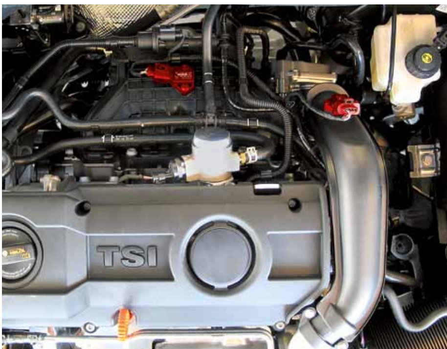
Senzorul de presiune al conductei de admisie (în stânga) și senzorul de presiune supraalimentare (în dreapta) la VW Golf VI (evidențiat cu roșu)
