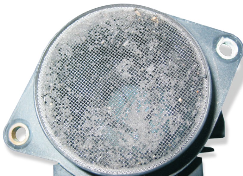
Sensore della massa dell'aria ostruito
