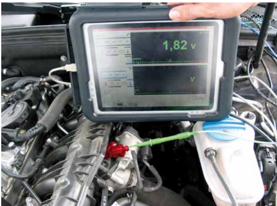
Medição da tensão de saída no sensor de pressão do tubo de aspiração (destacado) no Audi A4 TFSI
