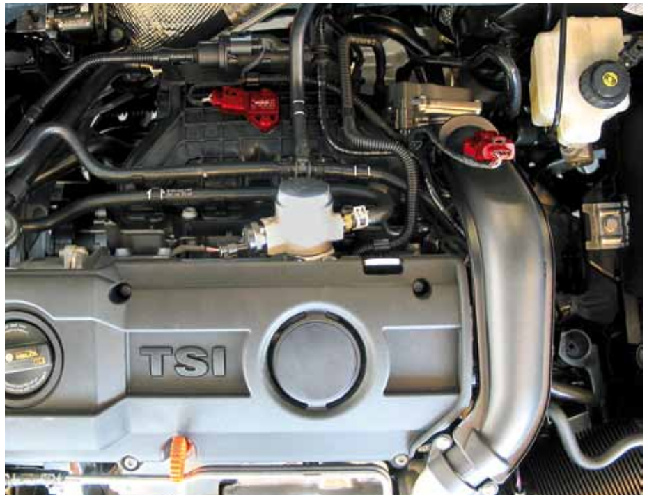
Sensor de pressão do tubo de aspiração (esquerda) e sensor de pressão de sobrealimentação (direita) no VW Golf VI (destacado a vermelho)
