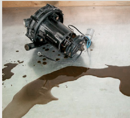
Abb. 28: Kondensat in der Sekundärluftpumpe
