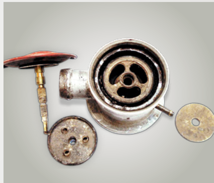
Abb. 30: abschaltbares Rückschlagventil – Schäden an Membrane und Ventilteller durch Kondensat
