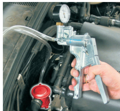
Test av en sekundärluftventil med en handvakuumpump
