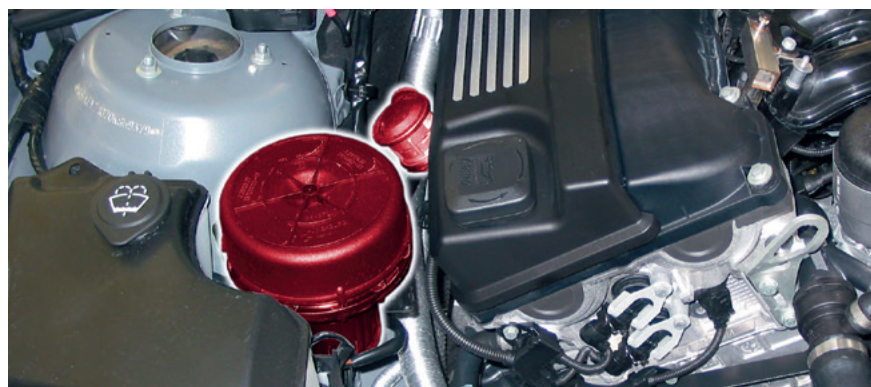
Sekundärluftventil och sekundärluftpump i BMW E46 (markerad)
