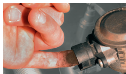
"Fingertest" på sekundärluftventil i BMW 520i (markerad) Om man hittar avlagringar på denna sida är backventilen otät och måste bytas ut.
