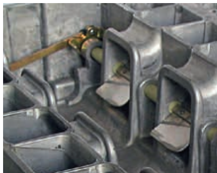
Ein Blick in das Innere eines Schaltsaugrohrs
