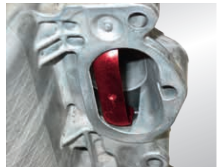
Tumbleklappe (rot hervorgehoben) für den Schichtladebetrieb
