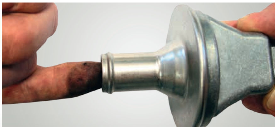
Obr. 1: Jednoduchá kontrola zpětného ventilu
