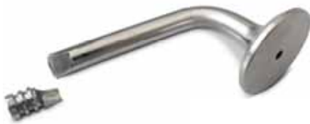
Fig. 1 : rupture en charge au niveau de l'entaille
