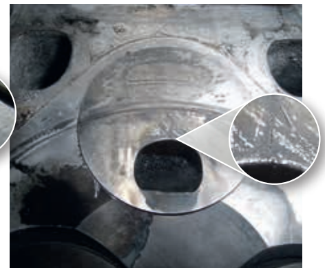
Abb. 2: Materialabschmelzungen und Rissbildungen an der Tangentialöffnung einer Wirbelkammer
