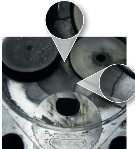
Abb. 1: Spannungsrisse im Zylinderkopf
