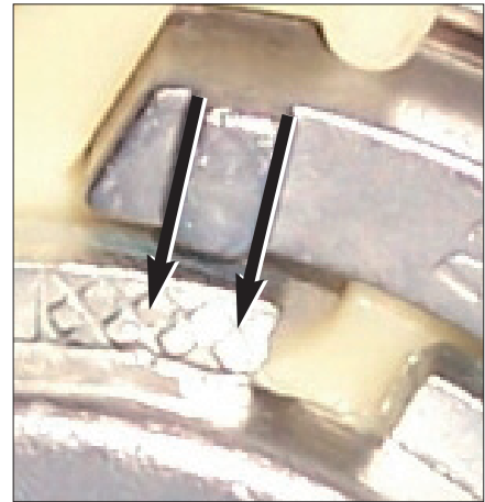
Beide Kerben stehen außerhalb der Aussparung (Pfeile). Einstellung muss korrigiert werden!
