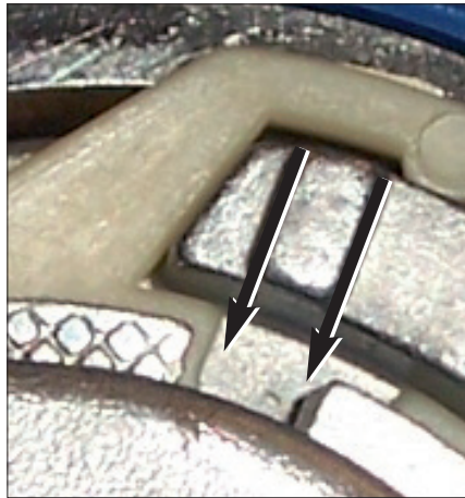
Beide Kerben stehen in der Aussparung (Pfeile). Diese Einstellung ist richtig!
