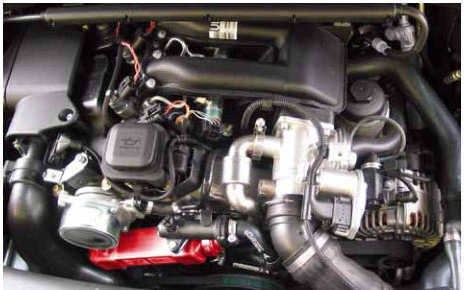
Fig. 2: Radiatore EGR in una vettura BMW 318d (evidenziato in rosso)
