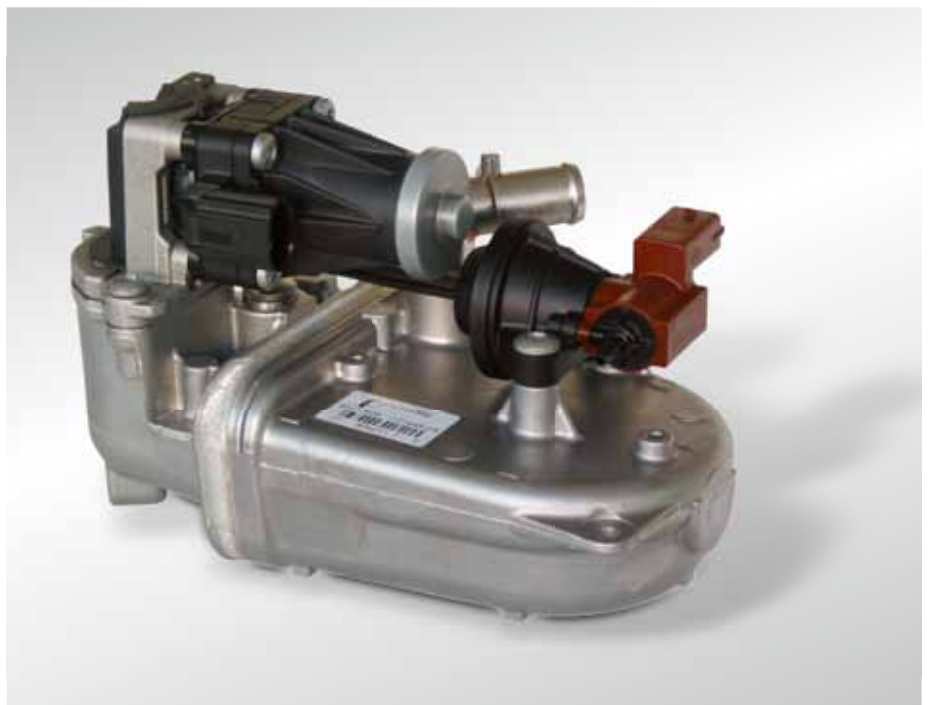
Fig. 3: Modulo radiatore EGR di PIERBURG con valvola EGR integrata e farfalla di bypass, montato in modelli Fiat e GM
