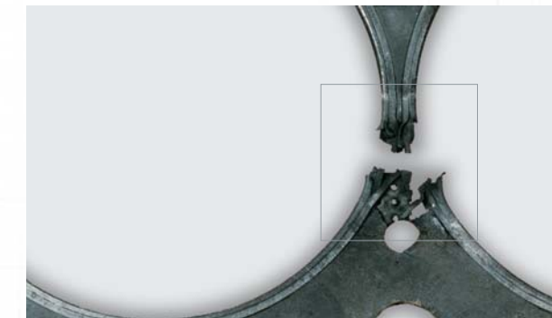
Zerstörungen im Stegbereich durch Überblasen von Brenngasen.
