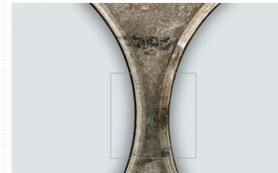
Gasleckage mit lokaler Schwarzfärbung der Brennraumeinfassung.
