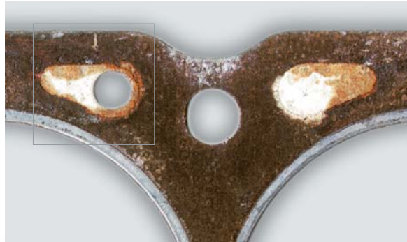
Aufquellungen bei Weichstoff-Zylinderkopfdichtungen durch Überhitzung mit Dampfbildung.
