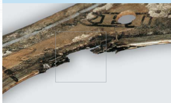
Eindellungen und Verquetschungen mit und ohne Überblasen durch Klingelbetrieb.
