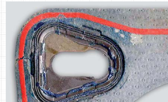
Reißen bzw. Ausbrechen des Weichstoffmaterials und beschädigtes Viton-Element durch unsachgemäßes Auftragen von zusätzlichen Dichtmassen.
