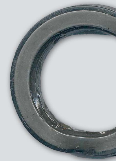
Gefettete PTFE-Dichtlippe als Ausfallursache.
