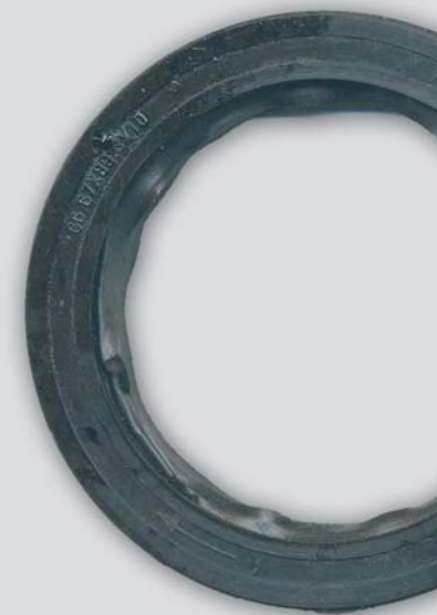
Beschädigte PTFE-Dichtlippe als Ausfallursache.
