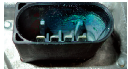
Einbaustecker mit Korrosionsspuren
