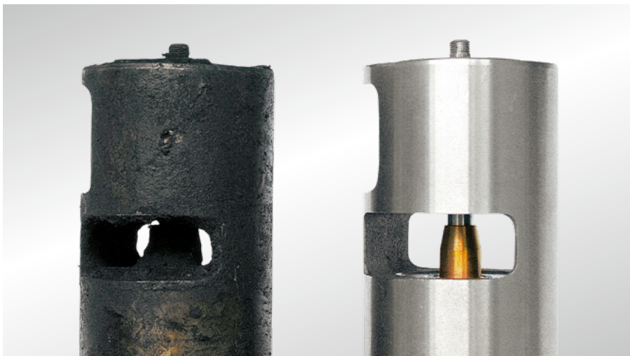
Fig. 38 Valve EGR (diesel) avec d'importants dépôts et à l'état neuf
