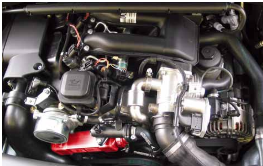
Fig. 2: Radiatorul EGR la un BMW 318d (evidențiat cu roșu)
