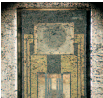
Du sel ou de la crasse peut avoir endommagé le capteur d'un débitmètre d'air massique – ou du moins falsifier les mesures, ce qui influence également le comportement de la vanne EGR.
