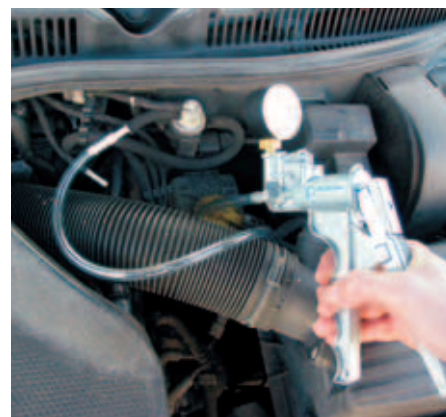
Qu'il s'agisse d'une vanne EGR pneumatique ou d'un convertisseur de pression électropneumatique (EPW) comme dans ce cas : le fonctionnement peut être facilement contrôlé à l'aide d'une pompe à vide manuelle.
