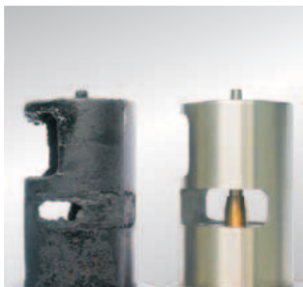
Du fait qu'une vanne EGR ne s'encrasse pas à froid toute seule, l'origine des dépôts de suie doit être recherchée et détectée.
