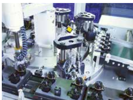
Fig. : Fabrication de soupapes de dérivation d'air dans l'usine Pierburg de Neuss
