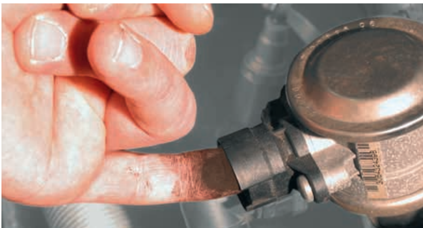
Schnellprüfung am Sekundärluftventil im BMW 520i (hervorgehoben)
