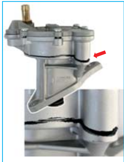
Fig. 1 Prasklé těleso čerpadla
