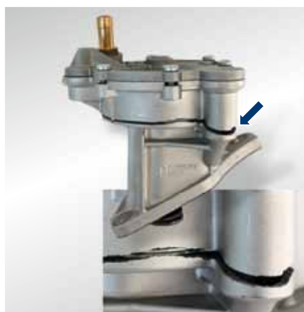
Fig. 1 : Rupture du carter de pompe
