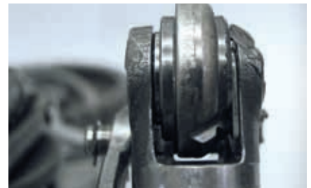
Vue du dommage : abrasion unilatérale du galet
