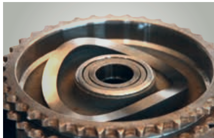
Came en bon état
