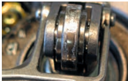
Vue du dommage : galet avec des encoches (piqûres) dues à l'usure de la came
