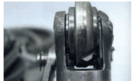
Obraz uszkodzenia: jednostronnie starty wałek
