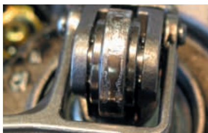
Tipologia di danno: rullo con tacche (vaiolatura o pitting) causate dall'usura
