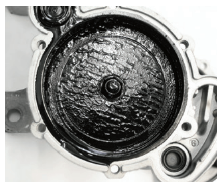
Fig. 3: La morchia nella pompa per vuoto di un VW Transporter produce un picchiettò
