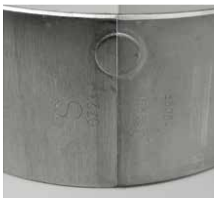
Występy ustalające panwi łożysk tocznych stanowiących oryginalne wyposażenie fabryczne. Kształt ten, określany też jako „moon version“, jest chroniony patentem.
