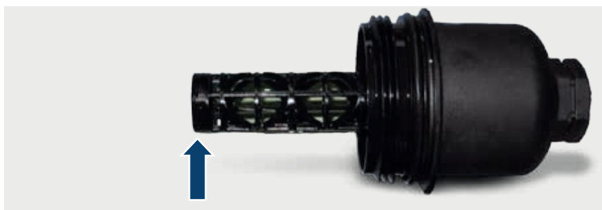
Fig. 2 : Cassure du tube en plastique, la fermeture pour la valve de drainage manque
