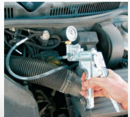
Pneumaattiset osat on helppo tarkastaa yksinkertaisia työkaluja käyttäen.
