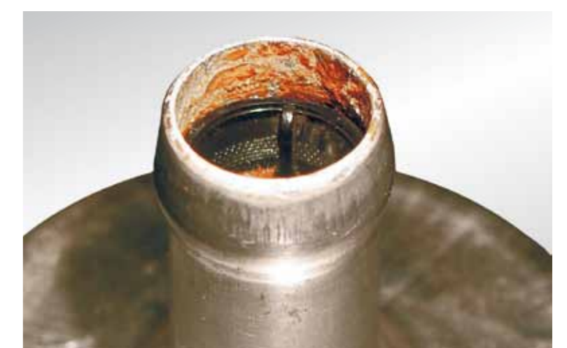
Rostat pumpinlopp (vattenskador)
