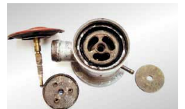
Válvula de retenção que pode ser desligada: danos (na membrana e no prato da válvula) devido ao condensado
