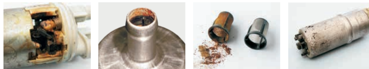
Danos por carbonização devido ao funcionamento a seco
