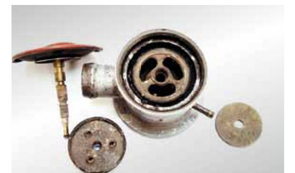
Vypínatelný zpětný ventil: Poškození (membrány a talíře ventilu) kondenzátem
