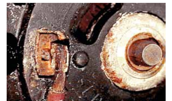
Čerpadlo sekundárního vzduchu – zkorodované elektrické přípojky
