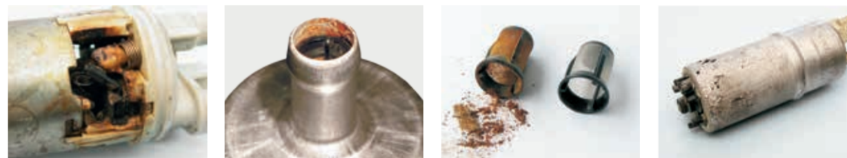
Szárazmenet okozta hőkárok
