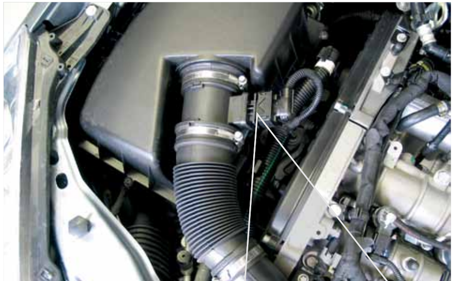
Sensor de masa de aire unido por soldadura
