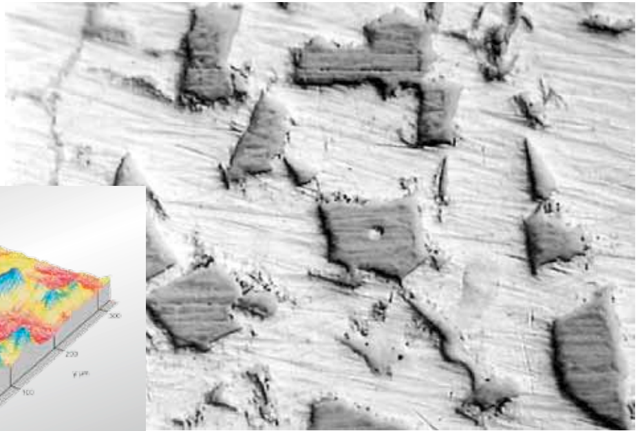
Fig. 2 Surface de travail du cylindre en Alusil (agrandie 150 fois)
