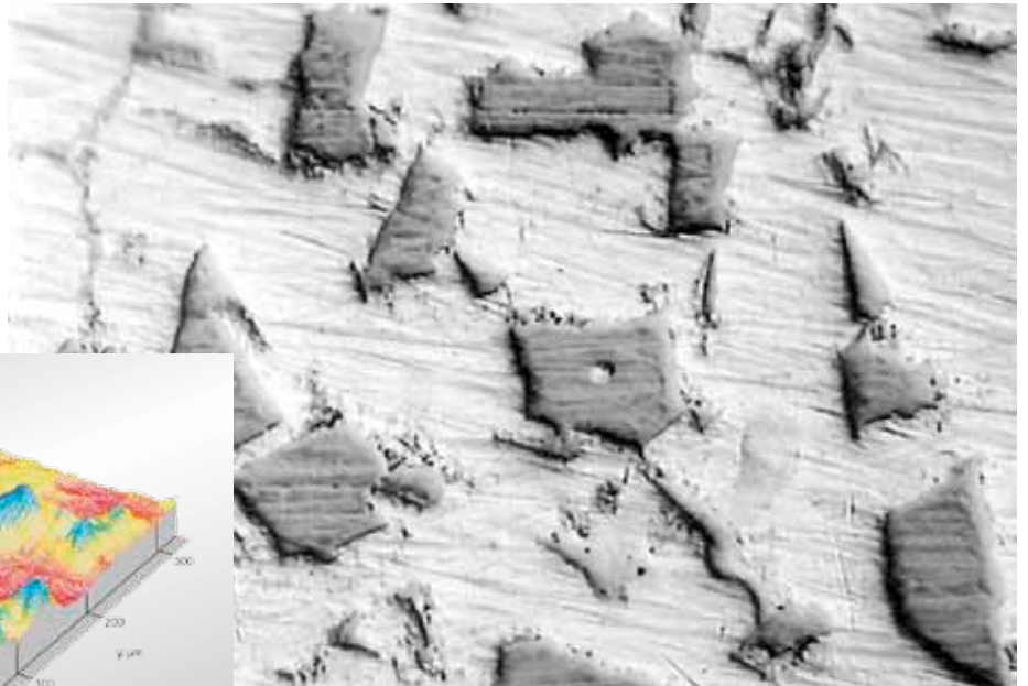
Abb. 2 Alusil-Zylinderlauffläche (Vergrößerung 150-fach)
