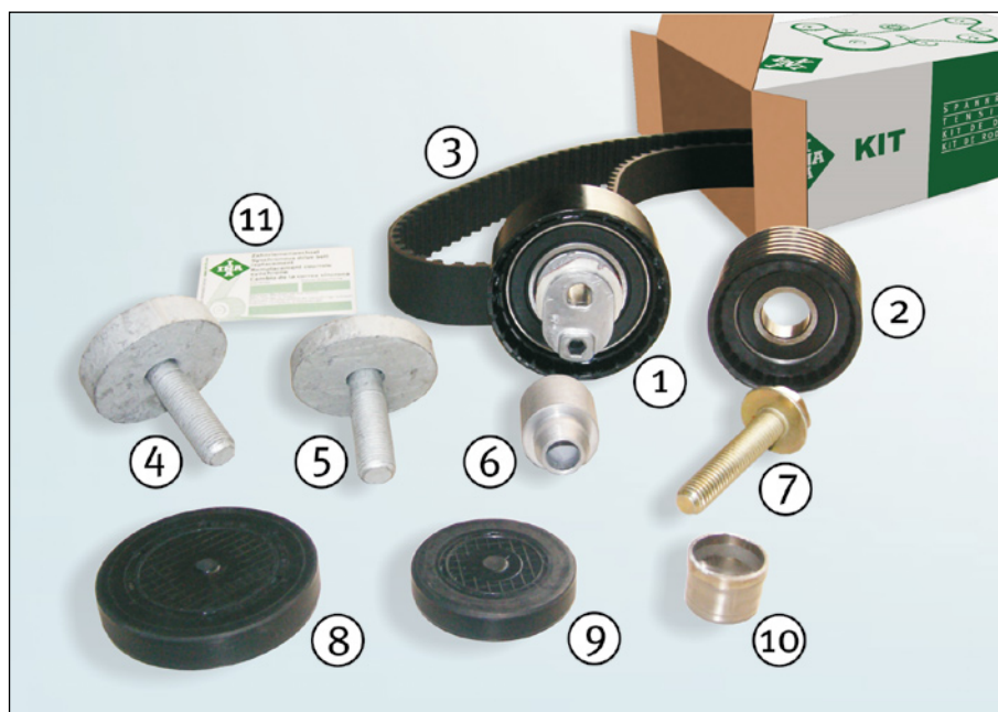
Bild 1 - zeigt das Zahnriemen-KIT 530 0363 10 mit vollständigem Inhalt
