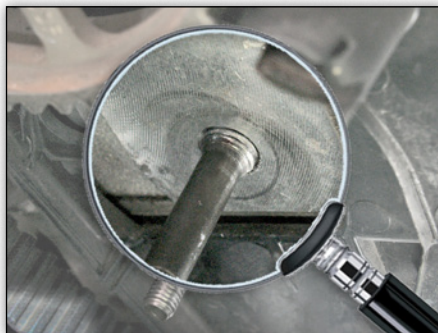
Bild 1: Der Stehbolzen ist nicht korrekt eingeschraubt.
