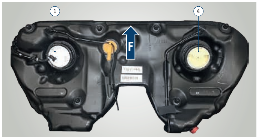
Fig. 4: Serbatoio del carburante (visto dall'alto)
