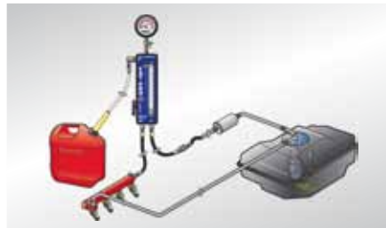
Exemple : dispositif de mesure dans le système d'alimentation en carburant avec retour
