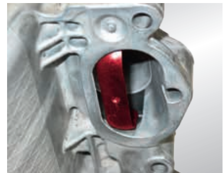
Válvula de turbulencia (resaltada en rojo) para el servicio con carga estratificada
